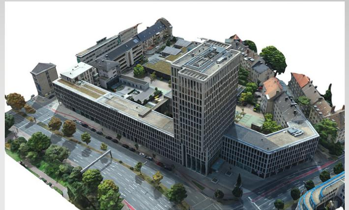
Das Ergebnis: „Die Flächen sind anschließend jederzeit digital begehbar.“ Der Kunde kann jeden Winkel des Gebäudes im Detail betrachten. Auch die Vermessung bestimmter Elemente (z. B. Fenstergrößen) ist vom Bildschirm aus direkt möglich.
